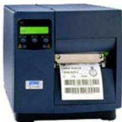
32 位处理器, 超大内存容量 超高打印速度 双锁定机构, 使得打印头压力均匀, 提高打印质量, 防止碳带皱折 5 键按钮, 液晶显示的前面板使得打印参数的设置简单方便 模块化设计, 易于重新配置和升级 精密的铸铝结构, 金属外壳, 胜任艰苦环境下的高负荷精确打印 机械构架合理, 使得安装标签纸, 碳带以及更换打印头等轻松快捷 提供并口和串口, 可选网络接口
