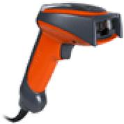
4800 工业级平面图像式二维条码阅读器，抗冲击能力为 2 米跌落水泥地面 50 次，防水防尘能力为 IP54 级，能在零下 30 度的温度环境下工作，可以全向采集所有类型的一维条码、二维条码、OCR、图像等，适用于恶劣的工作环境。
