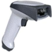
4600PDF/2D 同类产品性能最优异的图像式二维条码阅读器，采用了高性能处理器与先进的译码软件，能以非常快的速度采集包括 PDF417 码、QR 码在内的所有类型的一维条码、二维条码、OCR 字符、图像和签名等等。
